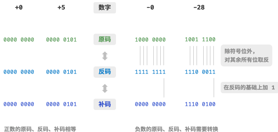
图 3-4 原码、反码与补码之间的相互转换
