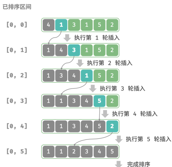
图 11-7 插入排序流程
