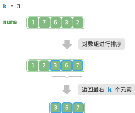
图 8-7 排序寻找最大的 k 个元素
