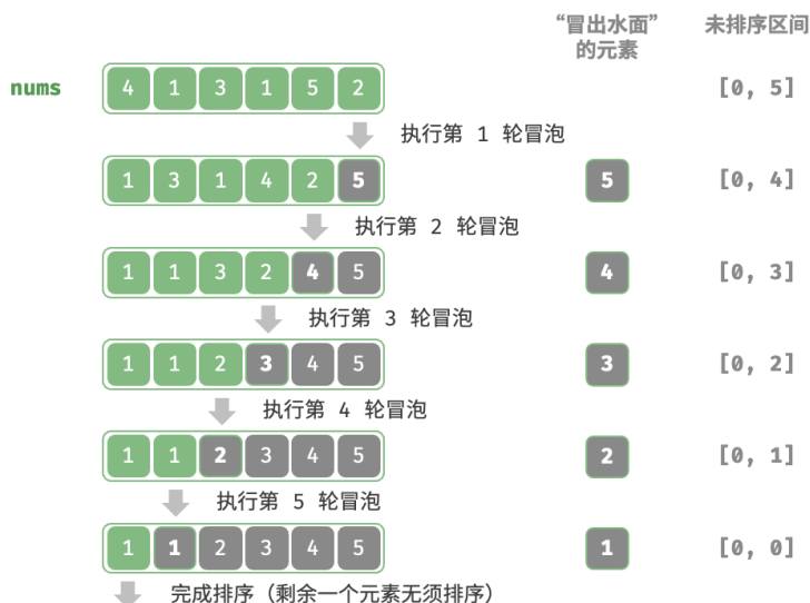
图 11-5 冒泡排序流程
