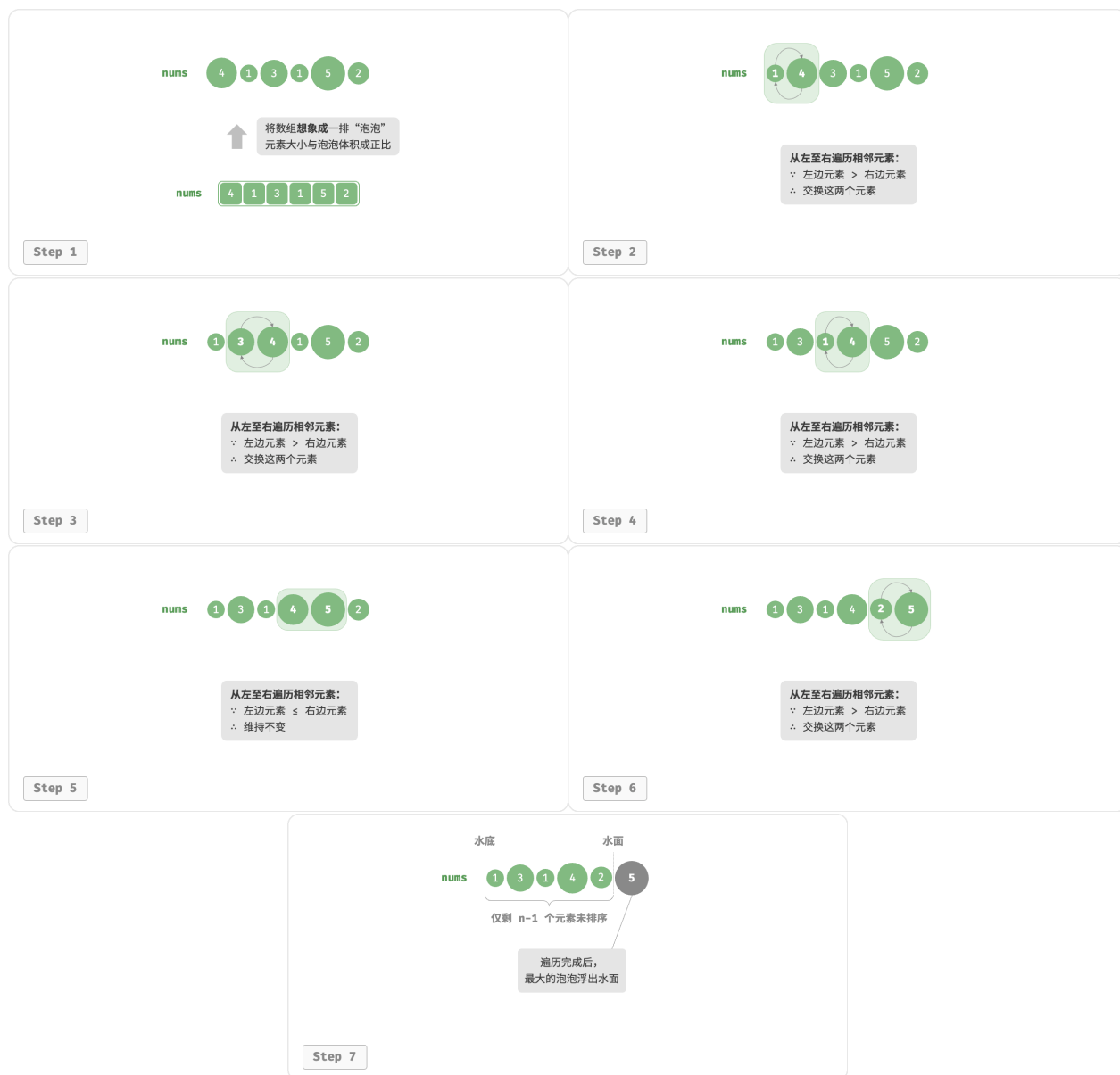
图 11-4 利用元素交换操作模拟冒泡
