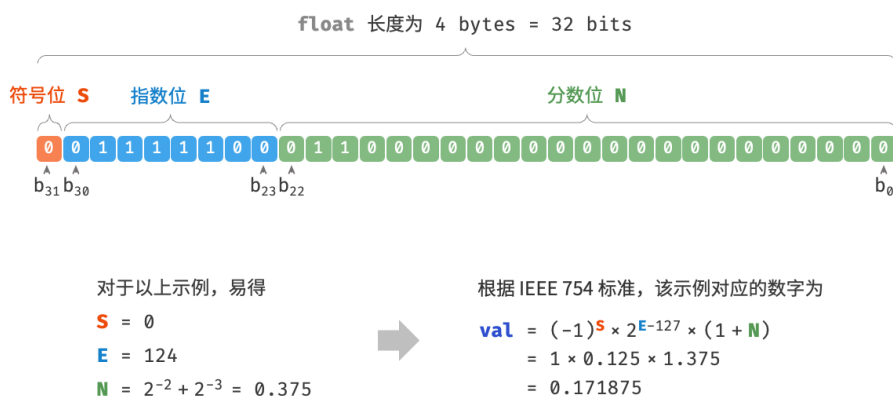
图 3-5 IEEE 754 标准下的 float 的计算示例
