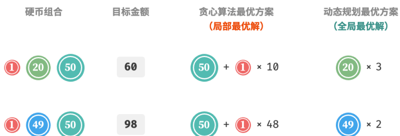
图 15-2 贪心算法无法找出最优解的示例
