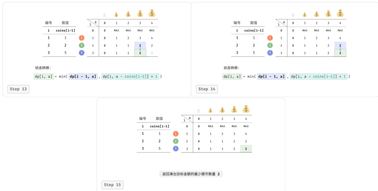
图 14-25 零钱兑换问题的动态规划过程
