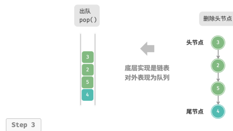
图 5-5 基于链表实现队列的入队出队操作
