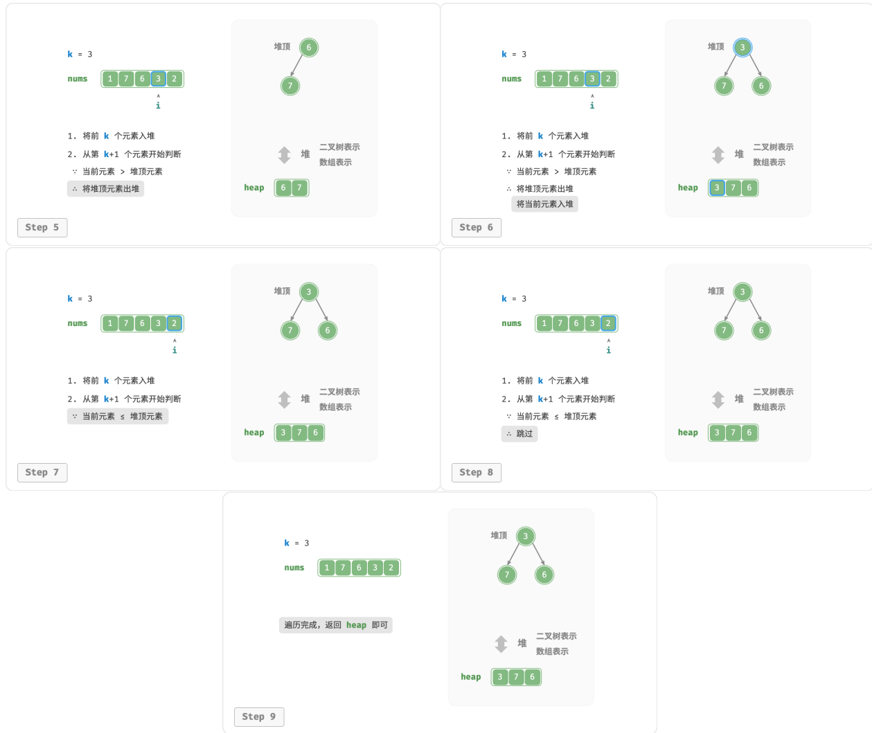
图 8-8 基于堆寻找最大的 k 个元素
