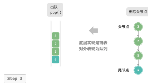
图 5-5 基于链表实现队列的入队出队操作
