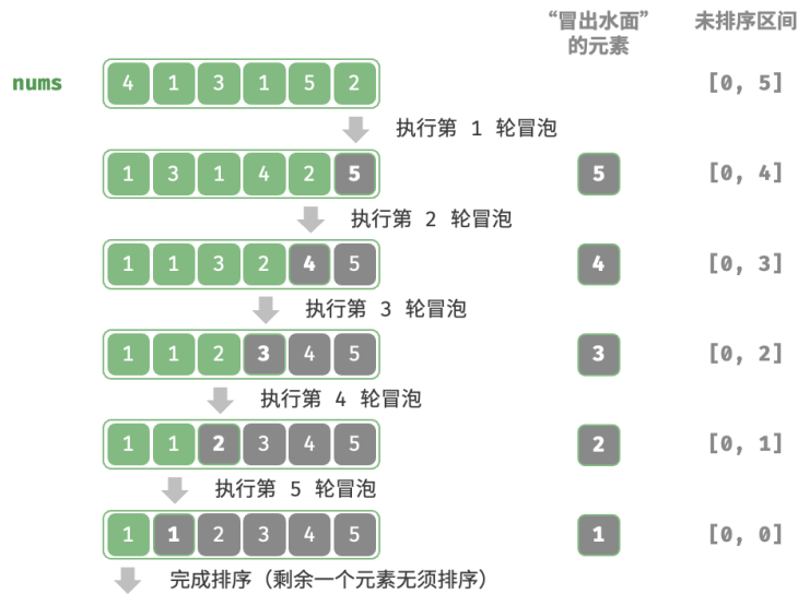
图 11-5 冒泡排序流程
