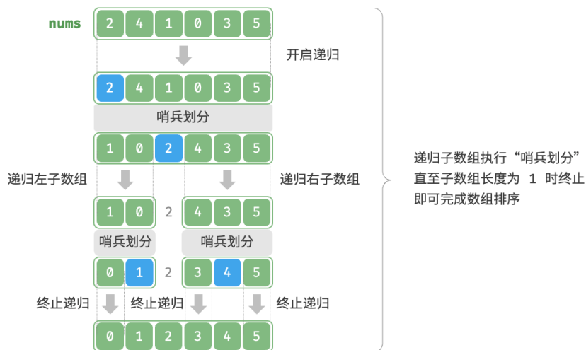
图 11-9 快速排序流程
