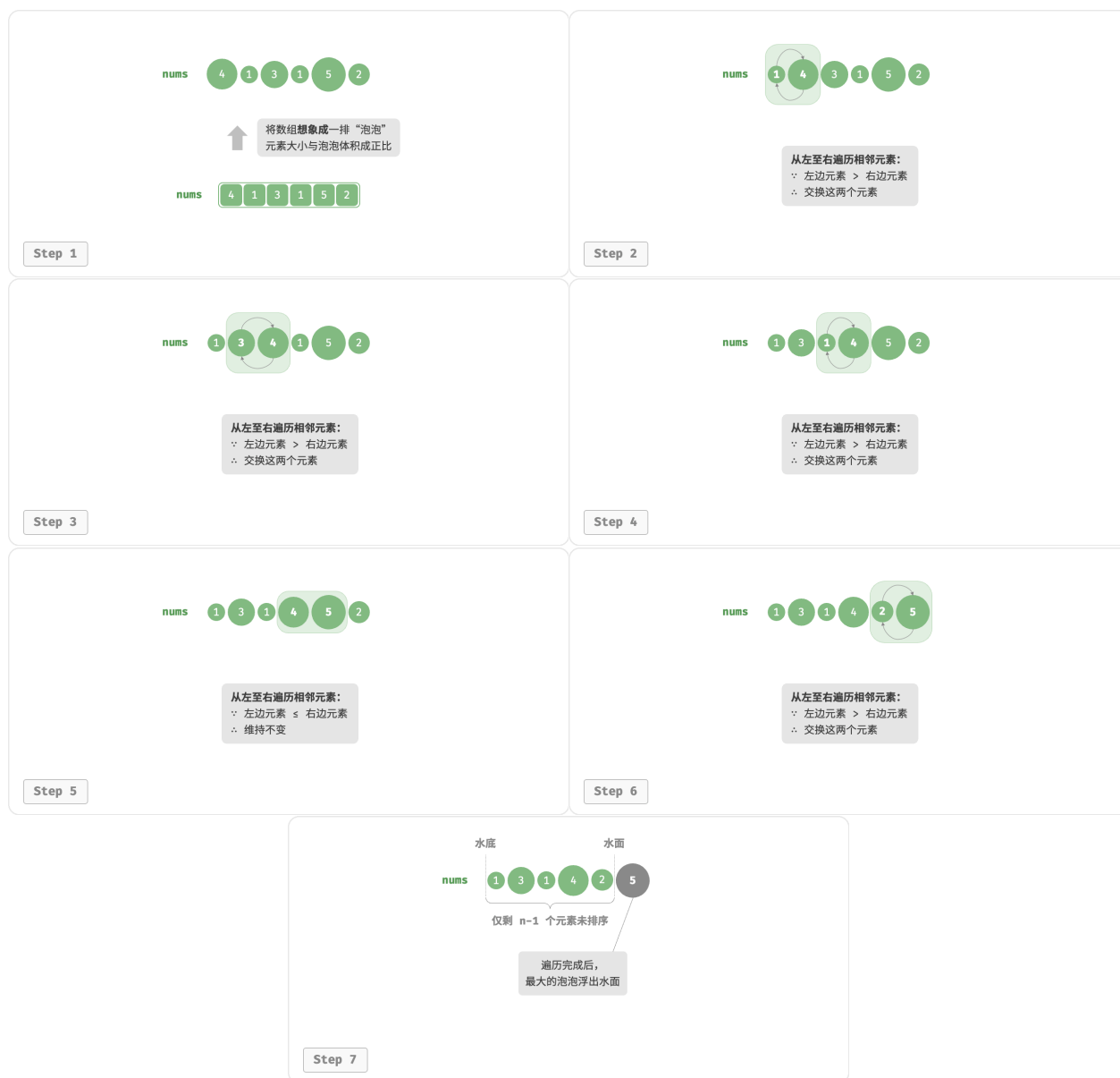
图 11-4 利用元素交换操作模拟冒泡
