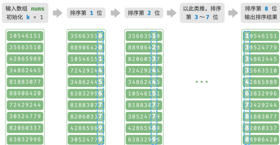
图 11-18 基数排序算法流程
